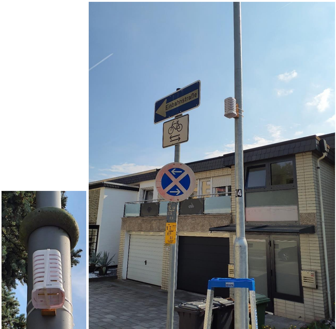
Abbildung 3. Wetterstation mit Belüftungsschlitzen und Montage eines Messgerätes an einem Mast der öffentlichen Beleuchtung. Fotos: Müller-BBM, 2024.
